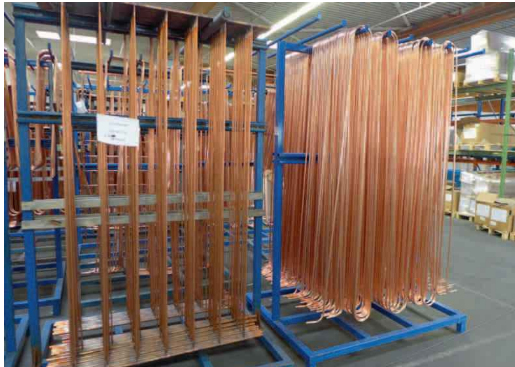
Im Lager nehmen die Absorberrohre relativ viel Platz in Anspruch, weil je nach Kundenwunsch Mäander, Parallelmäander, Harfe oder Doppelharfe eingesetzt werden.
