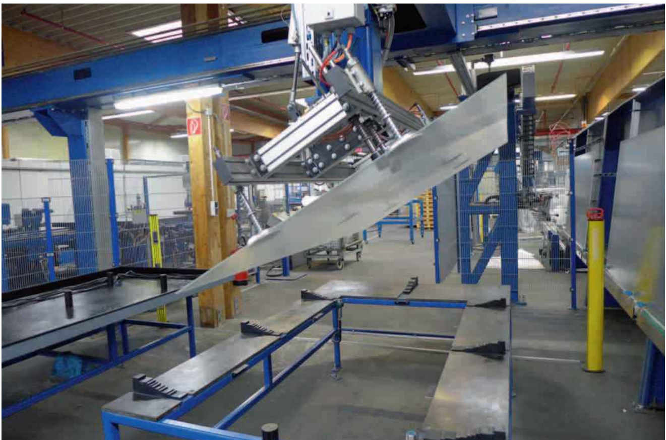
Die Glasscheibe wird vollautomatisch vom Stapel gehoben und zur Visierstation transportiert, wo vor einer Lichtwand eine Sichtkontrolle stattfindet.
