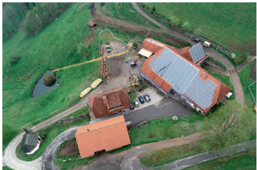
Die Kombination der Solarthermie mit der Photovoltaik ist sinnvoll, um den elektrischen Bedarf der solaren Trocknung zu decken. Die große Luftkollektoranlage weist nach Süden und dient der Beladung des thermischen Speichers für die Trocknung in der Nacht (Kapazität 5 Megawattstunden). Die kleine Luftkollektoranlage (Ost-West) ist für den Direktbetrieb der Trocknung vorgesehen. Die Trocknung beginnt bereits am frühen Morgen und endet am späten Abend.
