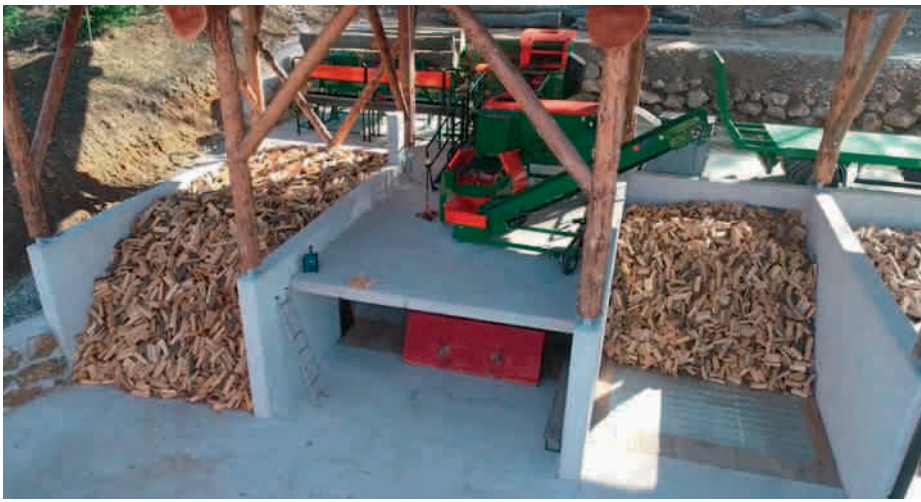
Solare Brennholztrocknung: In der rechten Trocknungsbox kann man den Belüftungsboden gut erkennen.
