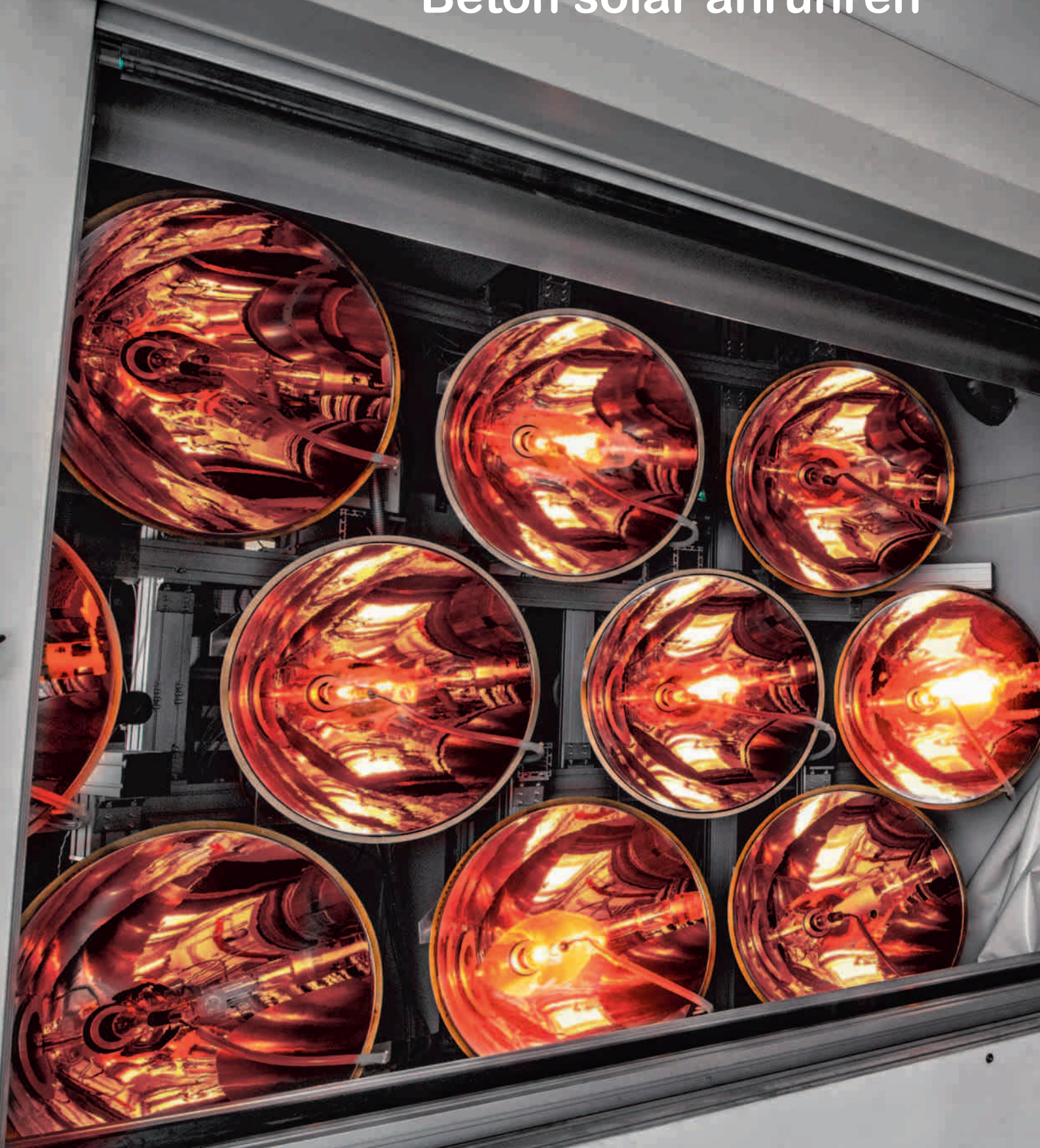
Der Solarsimulator am DLR-Institut in Köln besteht aus zehn Xenon-Kurzbogenlampen. Fotos (4): DLR
